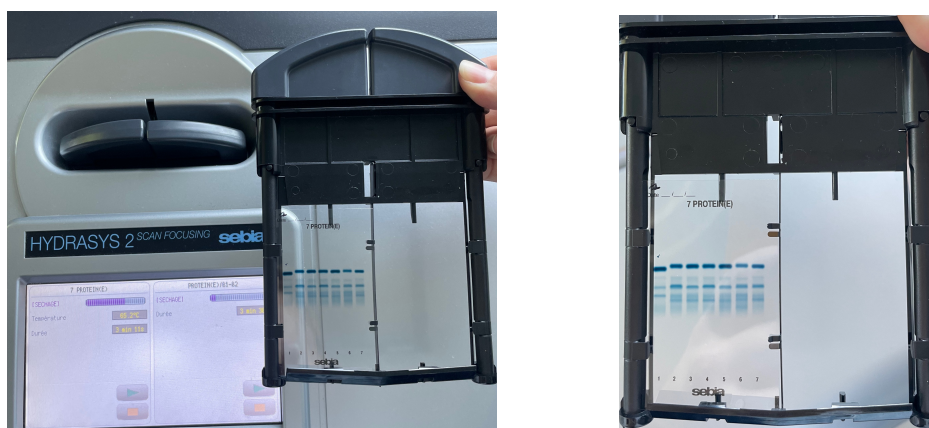
Figure 14 : Electrophorèse des protéines sanguines à l'aide de l'automate HYDRASYS2 SCAN FOCUSING (Sebia).
