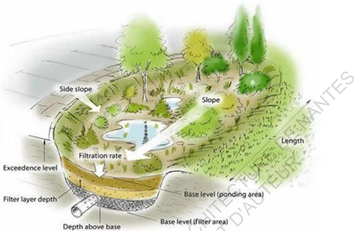
Figure 61 : Schéma de la structure du bassin de biorétention (Kingwei, 2020)
