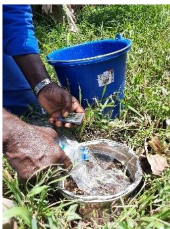
Figure 26 : Mesure de l'infiltrabilité du sol suivant la méthode Beerkan
