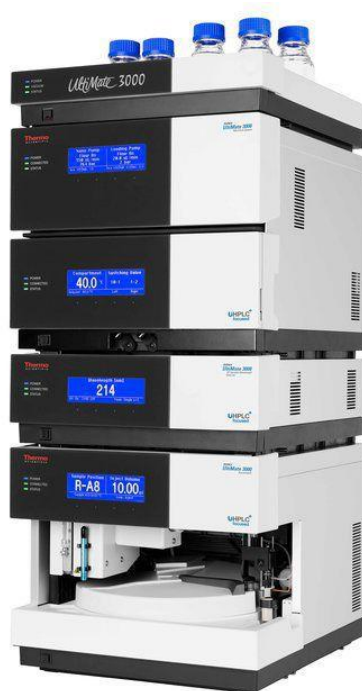
Figure n° 8 : HPLC Dionex Ultimate 3000®
