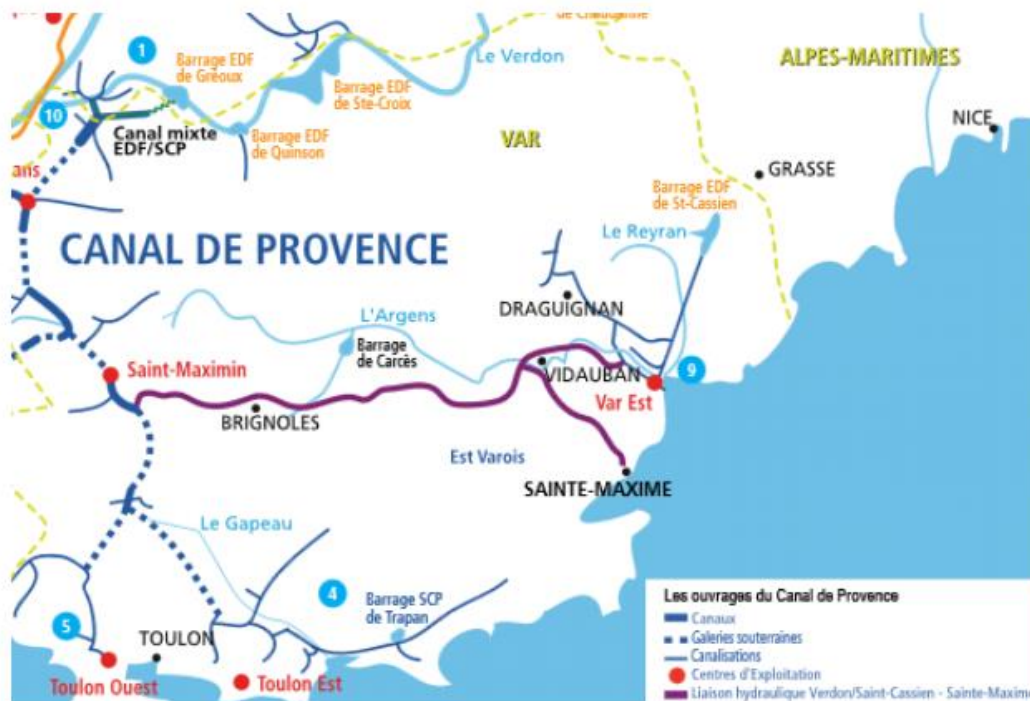
Figure 10 : Réseau Est du Canal de Provence avec la liaison Verdon - St Cassien. Source SCP
