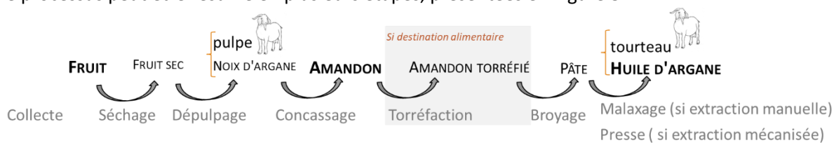
Figure 8: Schéma simplifié de l'extraction d'huile et coproduits. Source: auteur 28
