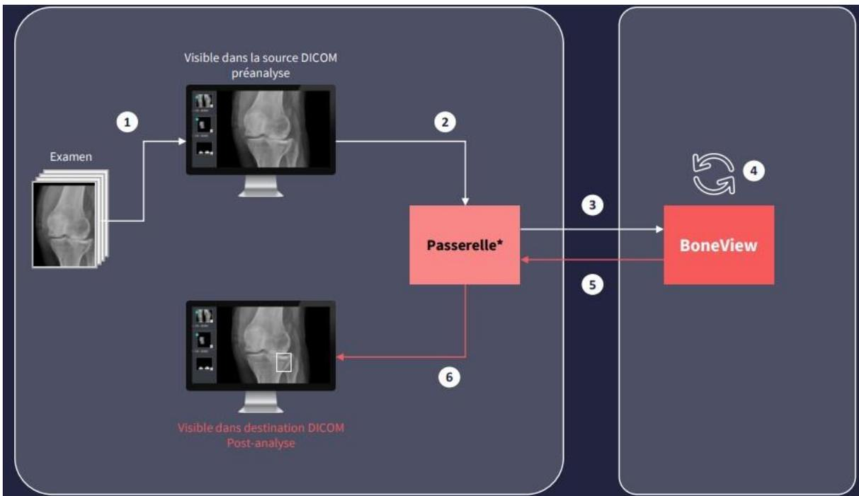
**Figure 8** : Principes de fonctionnement de Boneview
