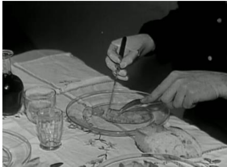
Figure 82 – Mutilé mangeant son repas avec une main électrocommandée, 1954
