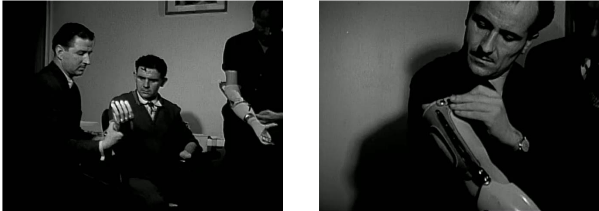
Figure 83 – Mise en place de la main électro-commandée, 1954
