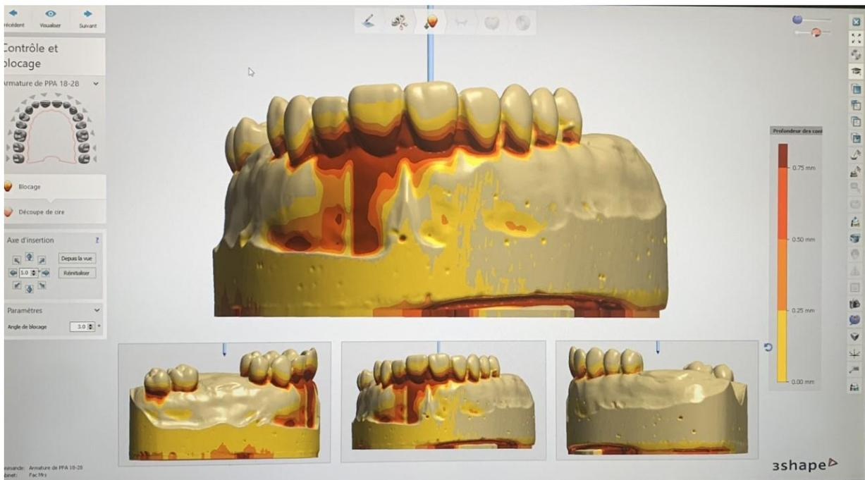
Figure 15 : Tracé des lignes guides et repérage des zones de contre-dépouille.
