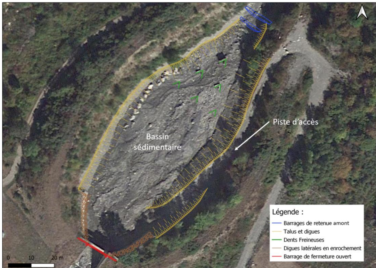
Figure 8 : Ouvrages de protection torrentielle composant le dispositif « plage de dépôts » du torrent du Claret. Réalisation : Leborgne (2022), Données : RTM73.
