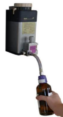
Figure 8 : Position de la bouteille d'isoflurane pour la vidange de la cuve
