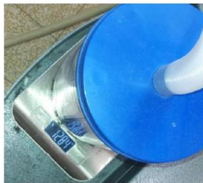
Figure 6 : Vérification de l'état d'usage du système de filtration des gaz par pesée
