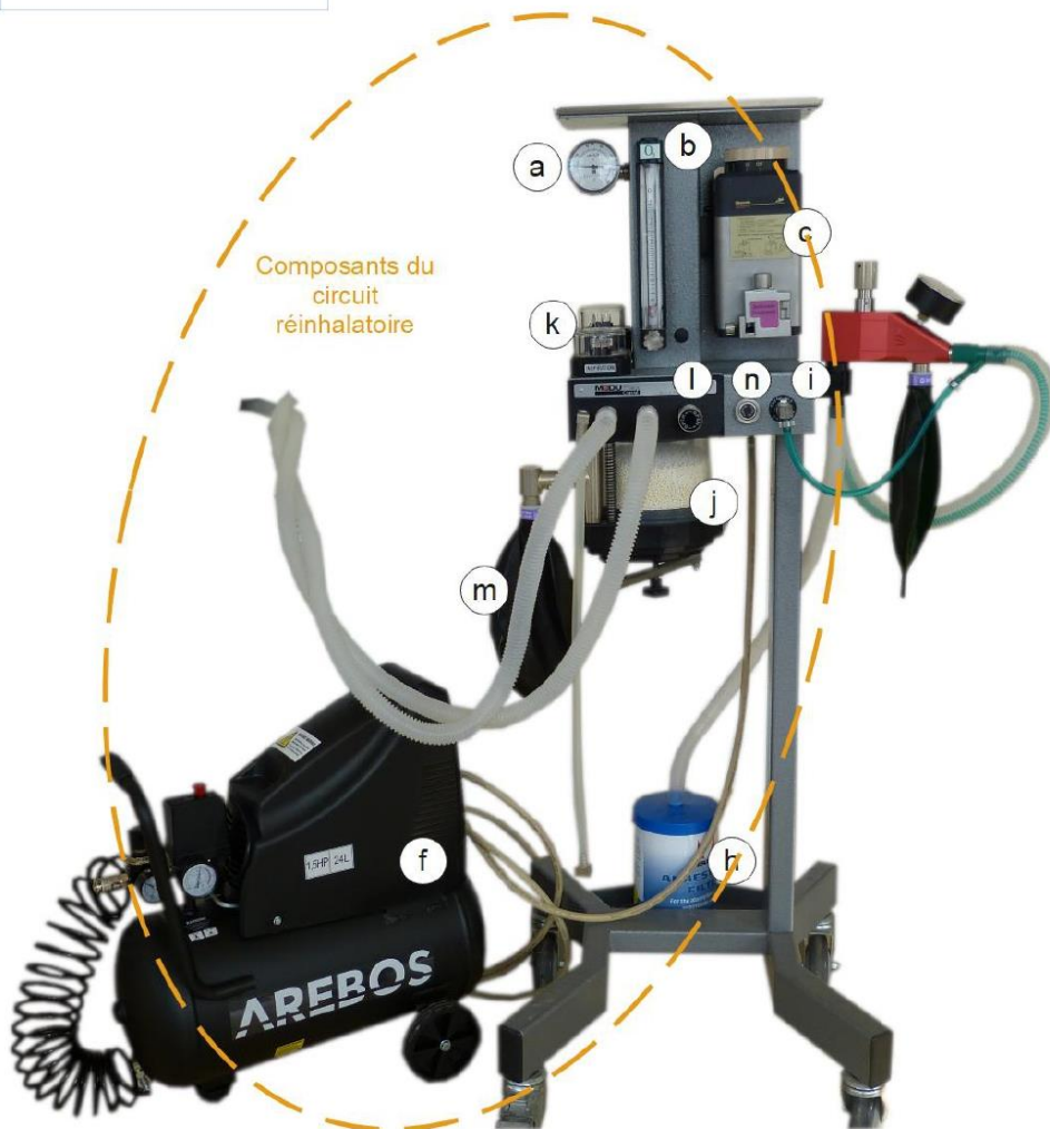
Figure 6 : Eléments composant le circuit réinhalatoire sur une photographie de la machine d'anesthésie
