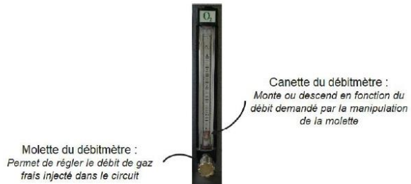
Figure 2 : Composants du débitmètre
