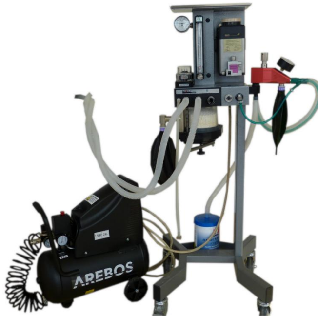
Figure 29 : Photographie de la machine d'anesthésie Moduflex® Coaxial et du compresseur d'air Arebos 24L utilisés pour les ateliers du parcours pédagogique de simulation de préparation d'une anesthésie gazeuse
