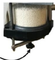
Figure 4 : Localisation de la vis maintenant le canister
