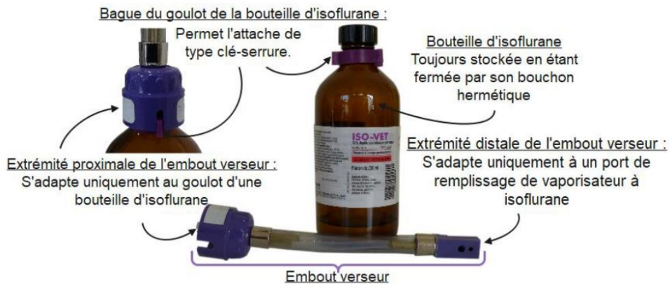
Figure 4 : Embout spécifique type clé serrure, du flacon d'isoflurane
