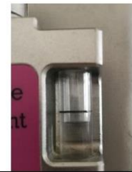
Figure 3 : Niveau d'anesthésique volatil insuffisant
