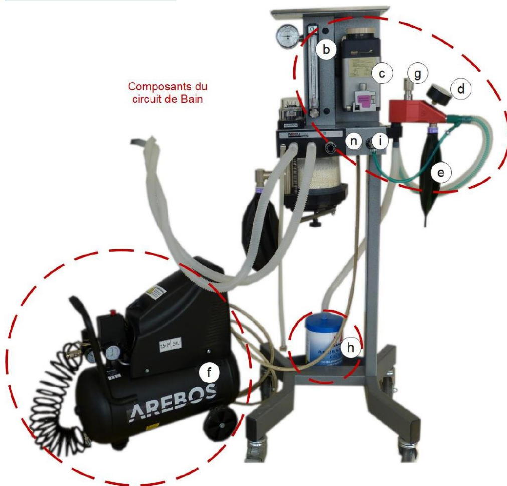
Figure 3 : Éléments composant le circuit non réinhalatoire de Bain sur une photographie de la machine d'anesthésie
