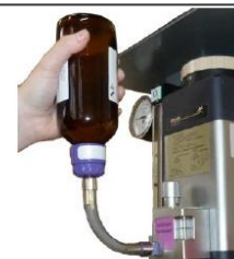
Figure 6 : Position de la bouteille d'isoflurane pour remplissage de la cuve
