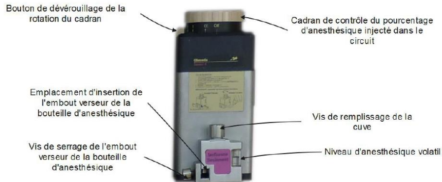
Figure 2 : Composants du vaporisateur
