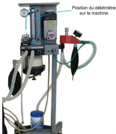
Figure 1 : Localisation du débitmètre sur la machine d'anesthésie
