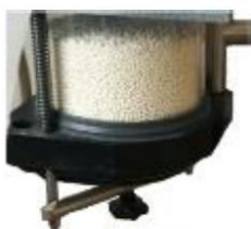
Figure 2 : Canister à chaux sodée : non colorée
