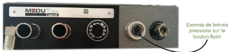
Figure 3 : Position du bouton flush sur la machine
