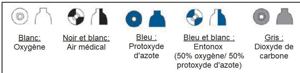
Figure 3 : Représentation du code couleur conventionnel des gaz médicaux (Alibhai, 2016)
