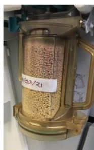
Figure 3 : Autre exemple de canister à chaux sodée ici usagées
