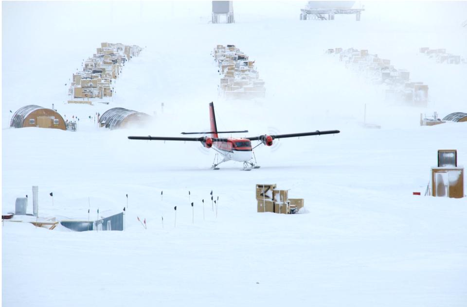
Figure 10 : Le Twin Otter, équipé de skis, effectue une rotation à la base antarctique Concordia.
