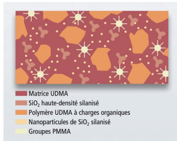
Figure 14 : Illustration de la structure NHC des dents Phonares commercialisées par Ivoclar Vivadent
