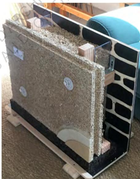
Maquette à l'échelle 1 réalisée par le fabricant (ITI panneau et remplissage sur bâti ancien)
