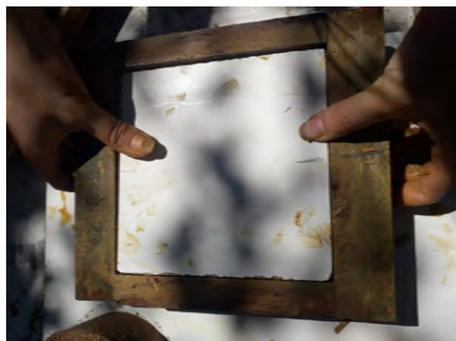
Démoulage d'une éprouvette parallélépipédique à l'aide d'une pièce de bois (pour limiter la dégradation des angles au démoulage)
