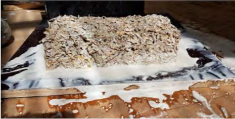
Écoulement d'un peu de liquide juste après le démoulage
