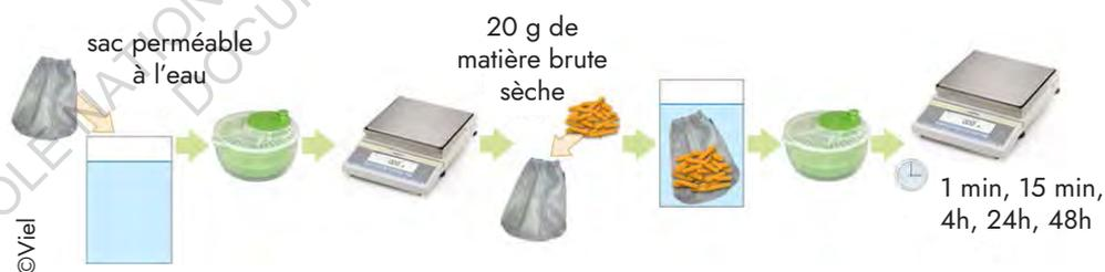
Protocole de mesure de l'absorption à l'eau
