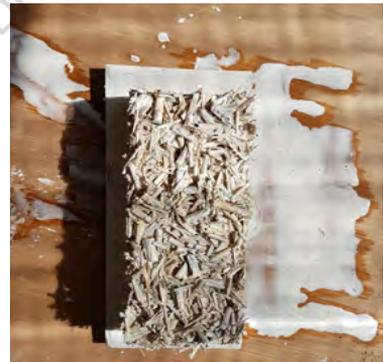
Écoulement de chaux mélangé à de l'eau après moulage
