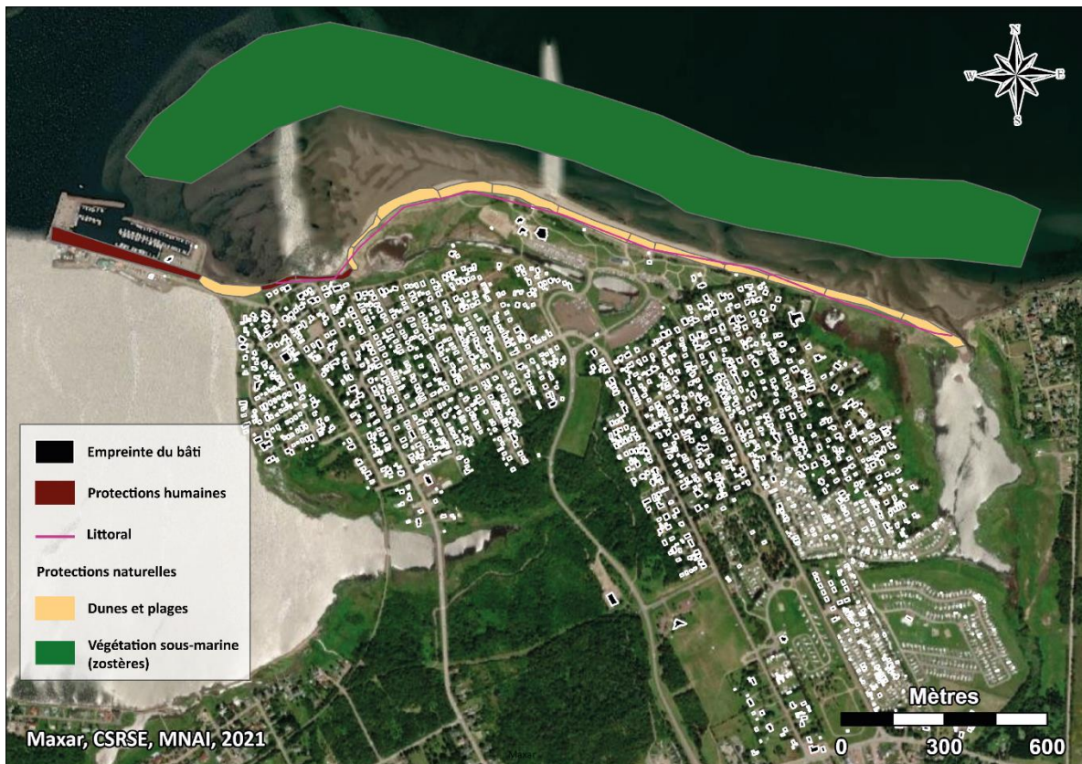
Figure 8 : Cartographie de la localisation des enjeux et des protections naturelles dans la communauté de Pointe-du-Chêne.
