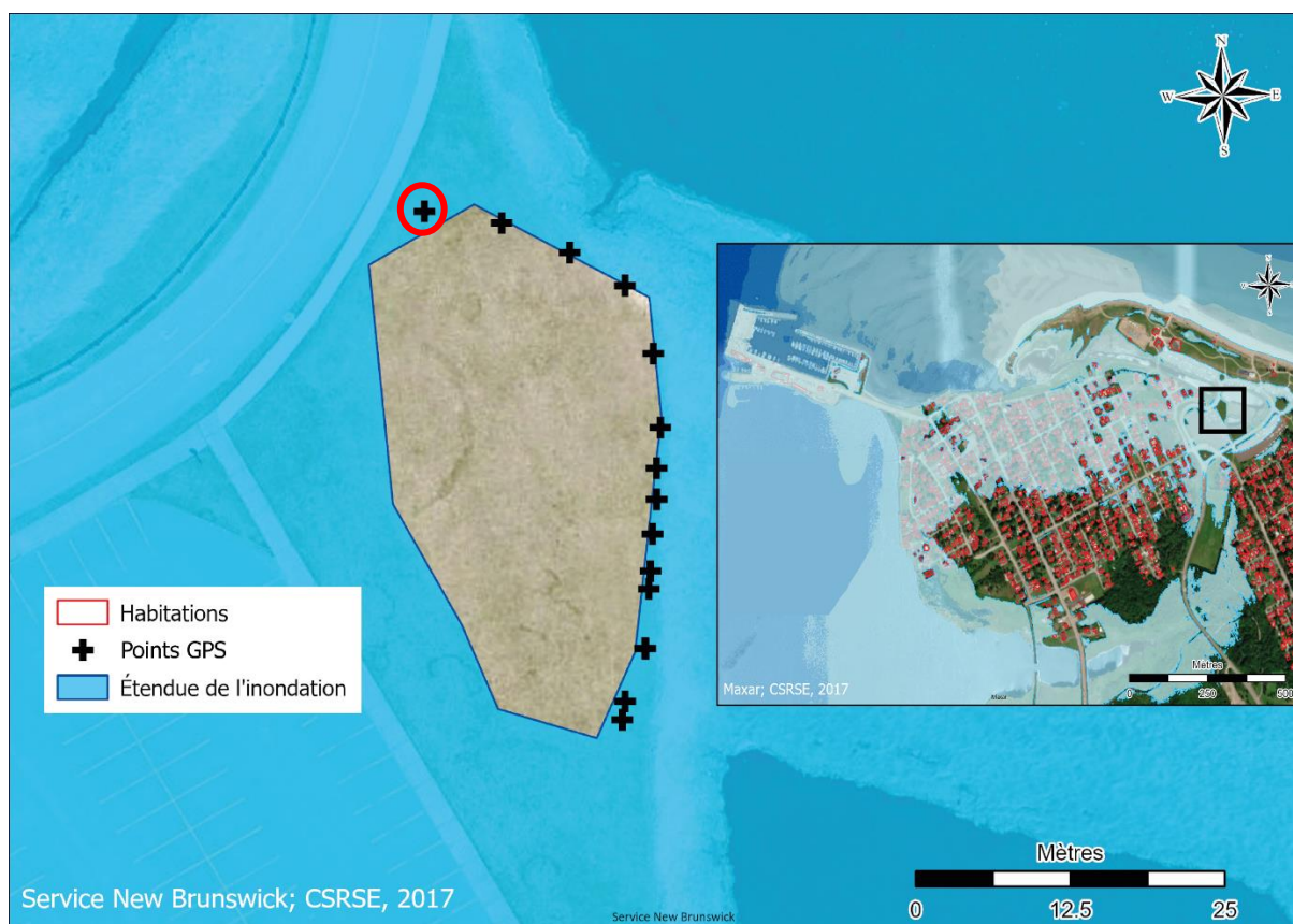
Figure 17 : Résultats de la simulation de la tempête du 21 décembre 2010 en comparaison des mesures effectuées et sur la communauté de Pointe-du-Chêne.
