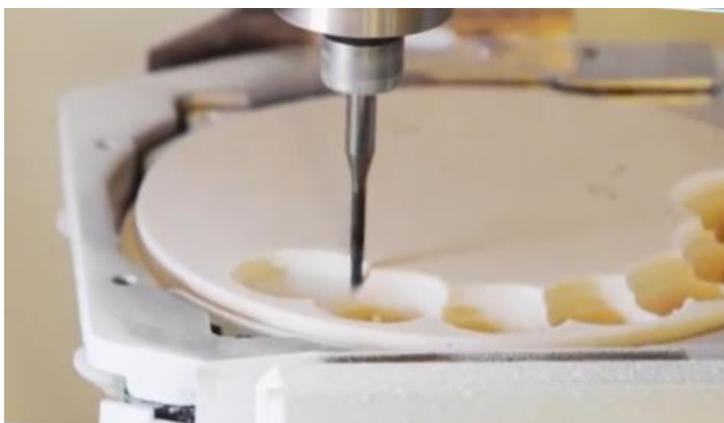
Figure 93 : Usinage de l'inlay-core dans une galette de résine Numerys GF® (117)
