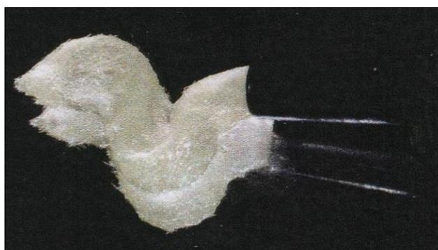
Figure 14 : Composite renforcé de fibres de verre courtes (EverX Posterior ®) (81).
