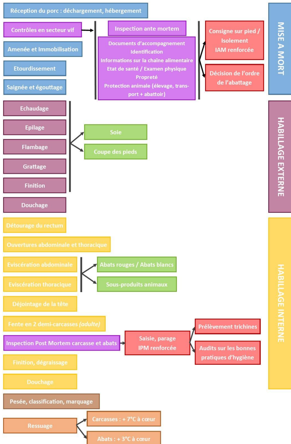
Figure 35 : Diagramme des étapes de la chaîne d'abattage des porcs
