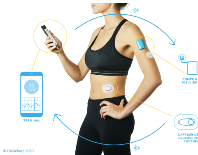
Figure 15 : Les éléments du système Diabeloop [71]
