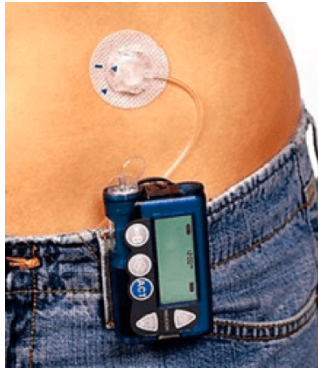
Figure 6 : Exemple de pompe à insuline avec cathéter [22]
