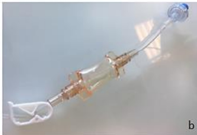
1b) Dispositif d'échantillonnage stérile sur le kit du ClinMACS Prodigy
