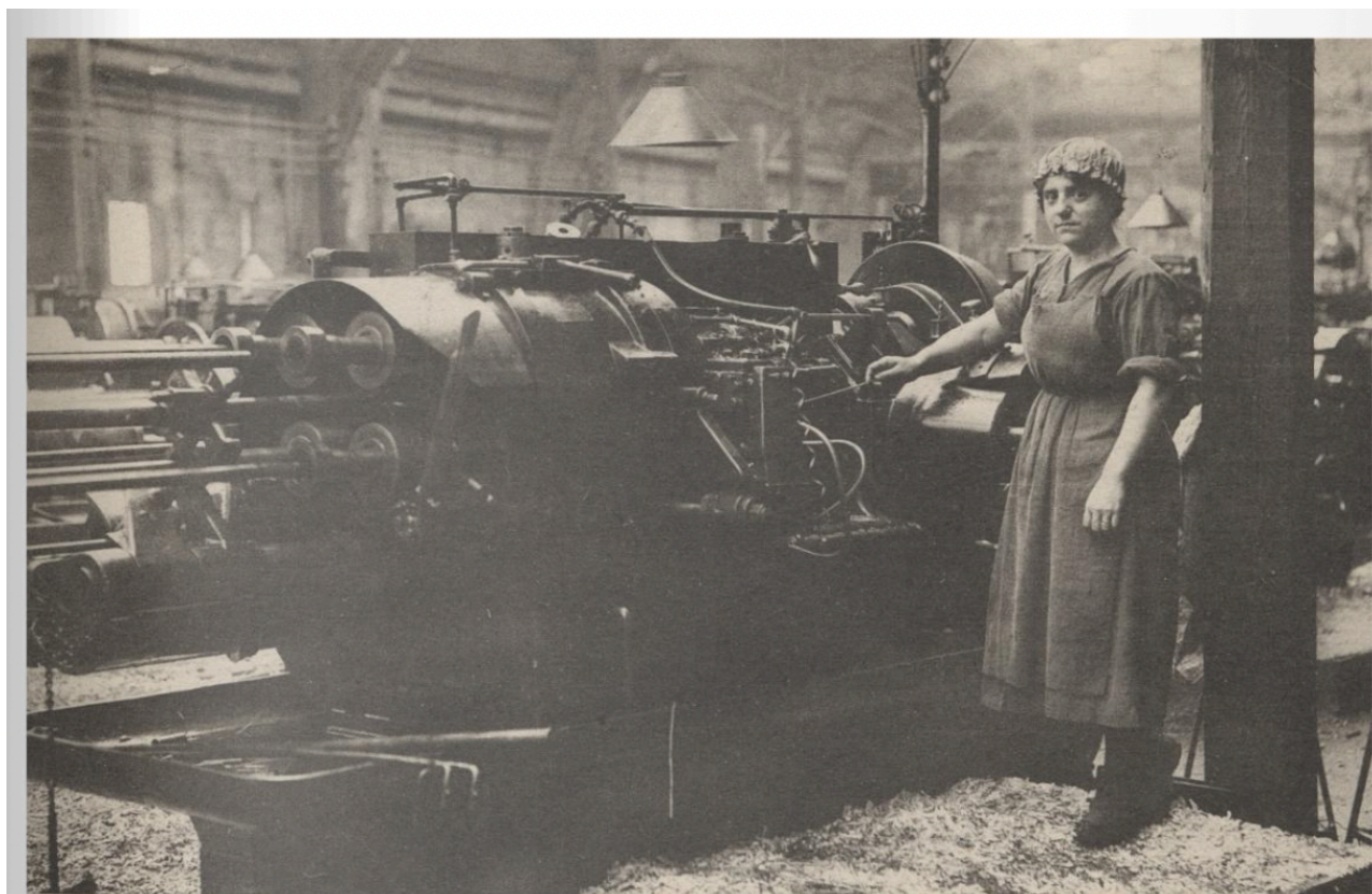
L'Eclairage Electrique, usine de matériel de guerre de Lyon. Décolletage (Tour Gridley à 4 broches). Lyon, 1914-1918. AML - 4 FI 4800
