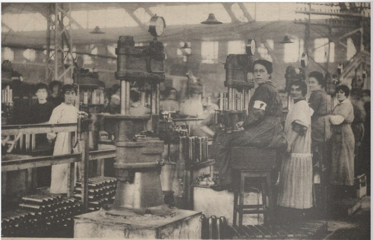
L'Eclairage Electrique, usine de matériel de guerre de Lyon. Essais à la pression. Lyon, 1914-1918. AML - 4 FI 4803
