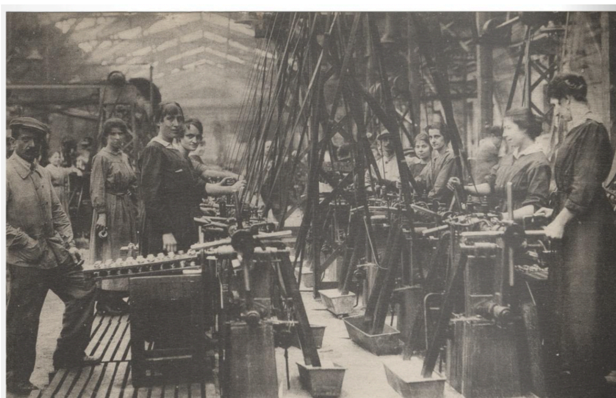
L'Éclairage Electrique, usine de matériel de guerre de Lyon. Filetage inférieur de la gaine. Lyon, 1914-1918. AML - 4 FI 4796
