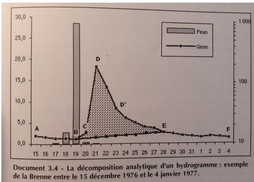
Illustration 13: Schéma tiré du livre "hydrologie fluviale" écrit par Alain Ginet représentant les différentes phases d'un hydrogramme. (A. Ginet 2007)
