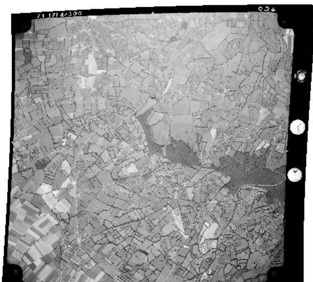
Illustration 4: Exemple de distorsions de l'image suite à un géoréférencement précis d'une photographie de 1971
