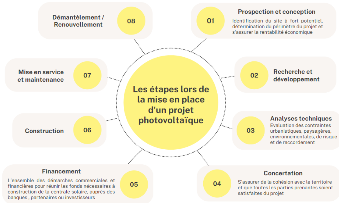
Figure 12 : Les étapes lors de la mise en place d'un projet photovoltaïque – source interne
