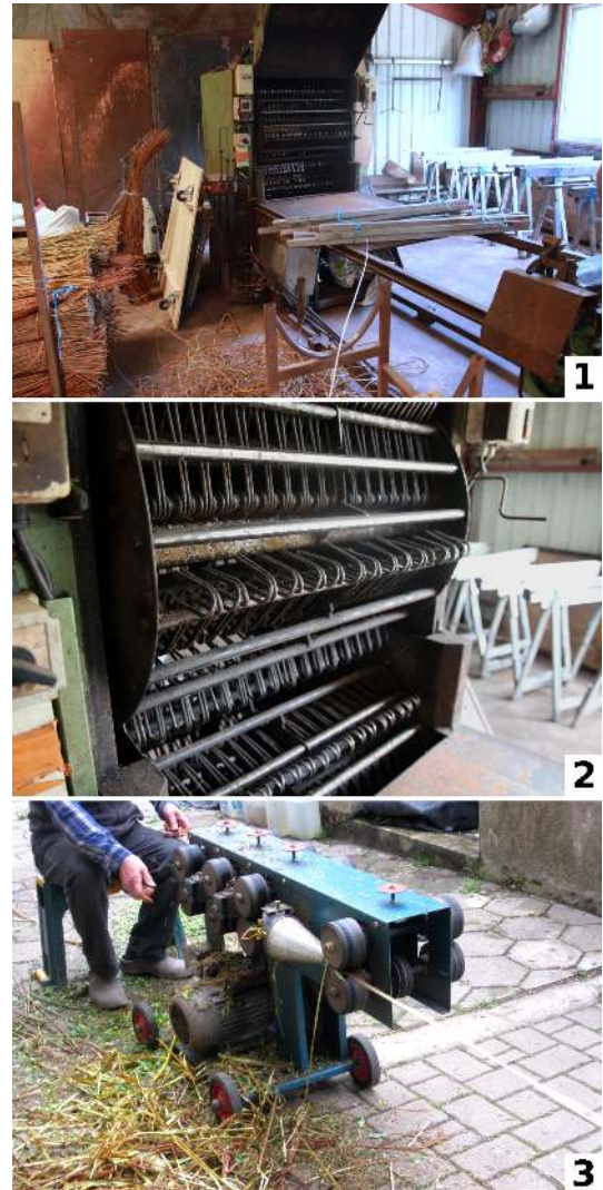
FIGURE 13 – Photographies d'écorceuses ; 1. écorceuse d'osier de la CUMA de Villaines-les-Rochers ; 2. même écorceuse vue de près : les barres de fer que l'on voit permettent d'écorcer l'osier ; 3. modèle d'écorceuse brin par brin n'utilisant pas d'eau – photographies personnelles
