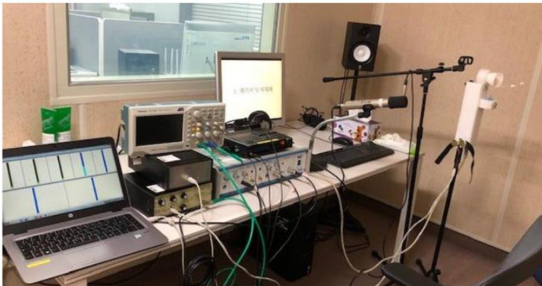
Figure 12. L'ensemble des dispositifs (EVA, EGG, oscilloscope) utilisés lors de la prise de données 7 .
