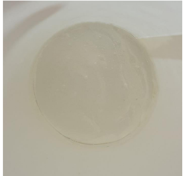
Figure 24 : Photos de résines durcies dans le verre suite au chauffage trop long et trop important du mélange
