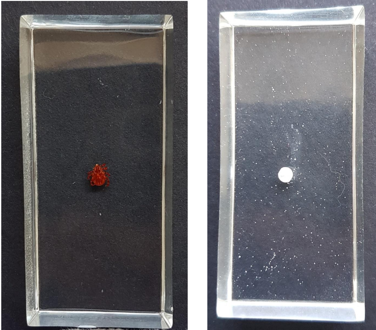
Figure 27 : Photos de comparaison des bulles restantes après dégazage à la pompe à vide (à gauche) et dégazage naturel (à droite) sur des résines de 2 coulées d'épaisseur
