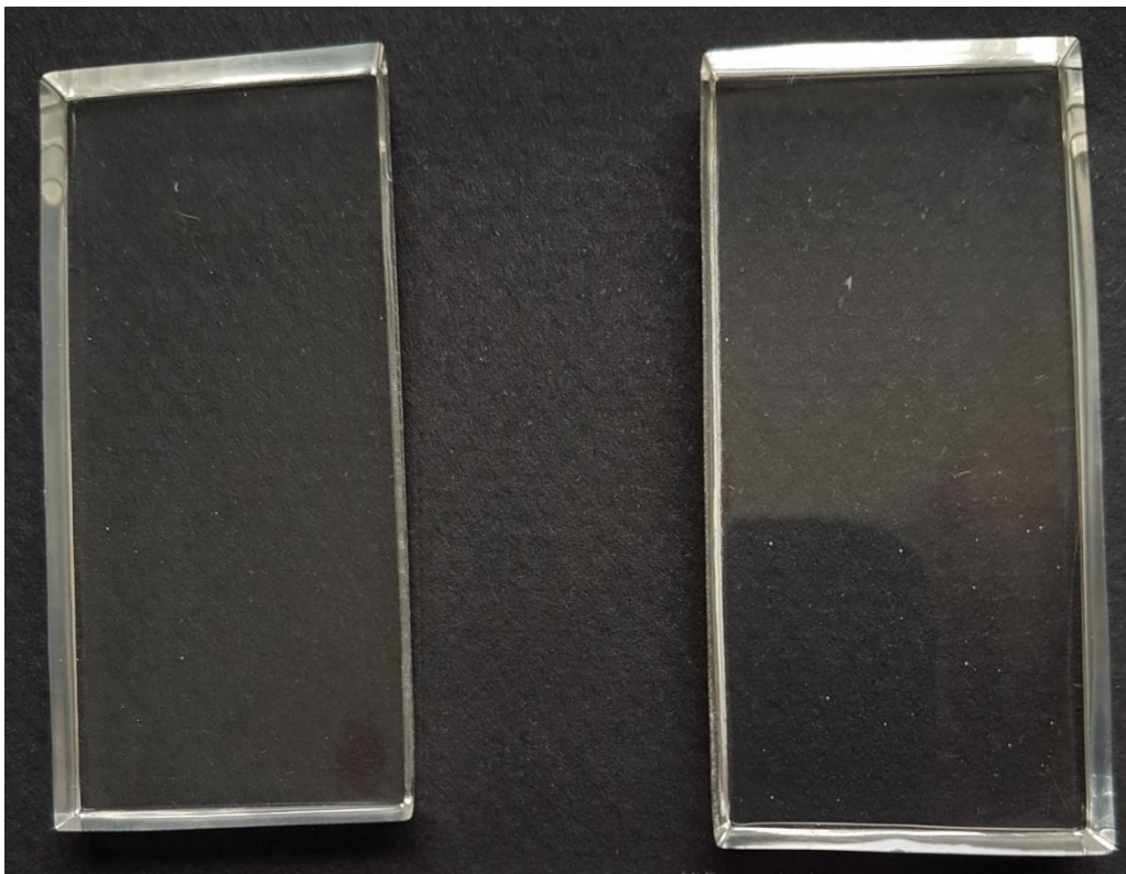
Figure 25 : Photos de comparaison du nombre de bulles restantes après dégazage à la plaque chauffante 3 minutes (à droite) et 4 minutes (à gauche).
