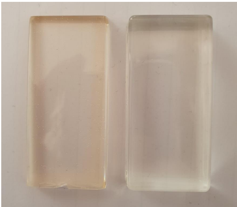
Figure 43 : Photos de comparaison de deux résines, à gauche conservée pendant plusieurs semaines sans protection contre les UV, à droite conservée à l'abri complet de la lumière dès sa création
