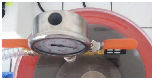
Photo 2: Position du robinet de la chambre à vide (fermé, entrouvert, ouvert)
