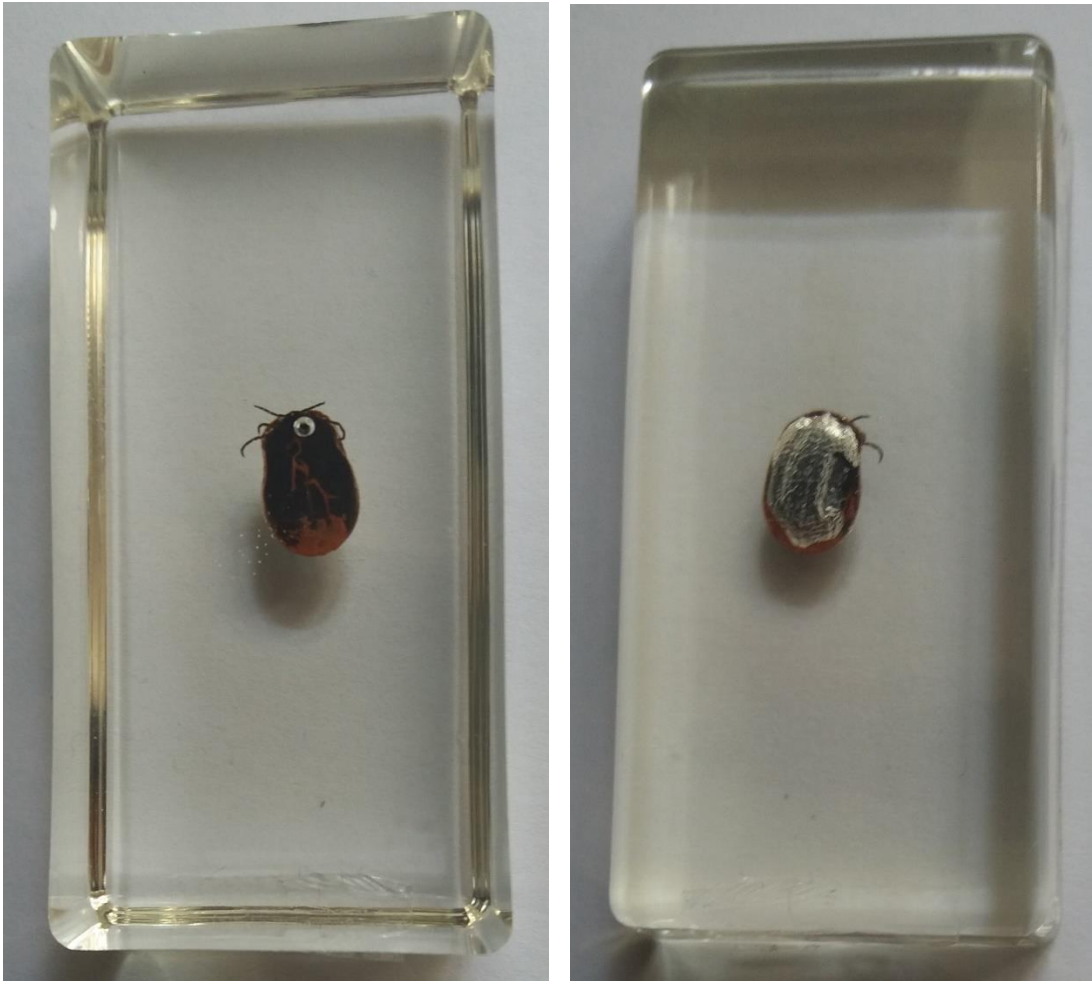
Figure 30 : Photos d'une même résine (2 mois d'âge), avec le dos (à gauche) qui a gardé la couleur d'origine, et le devant (à droite) recouvert d'un voile blanc
