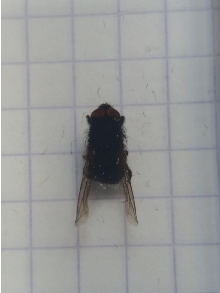
Figure 37 : Photo d'une mouche incluse en résine avec ses poils cassés, après tentative de recouvrement préalable au pinceau par de la résine
