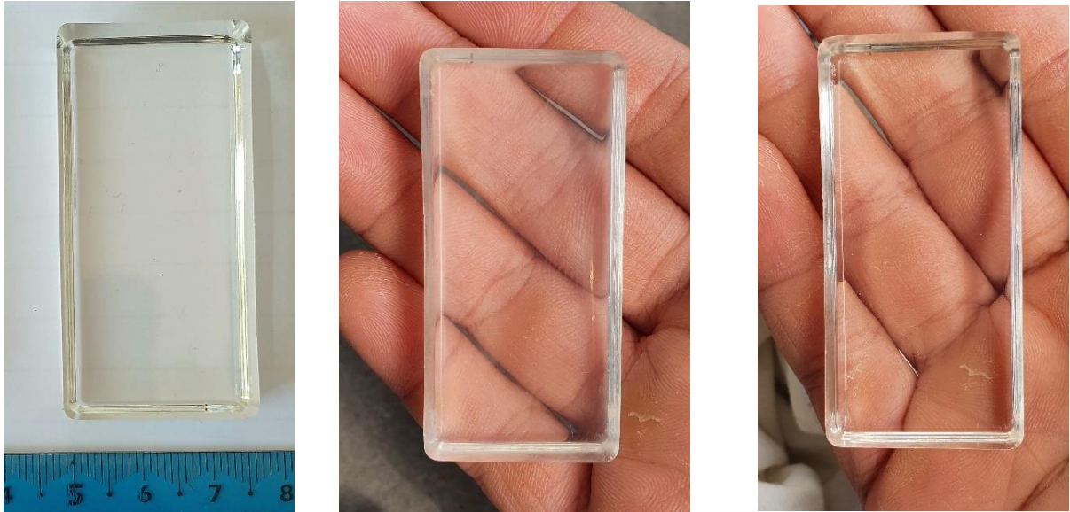
Figure 42: Photos d'une résine avant ponçage (à gauche), après ponçage (au milieu) et après ponçage et polissage (à droite)
