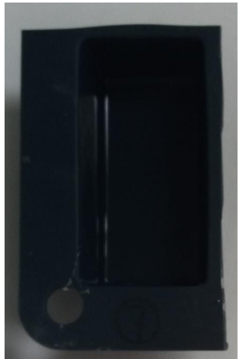
Figure 7 : Schéma (A) d'un moule en silicone noir utilisé lors de la réalisation d'une coulée de résine, en parallèle des exemples de moules utilisés (B ; C)
