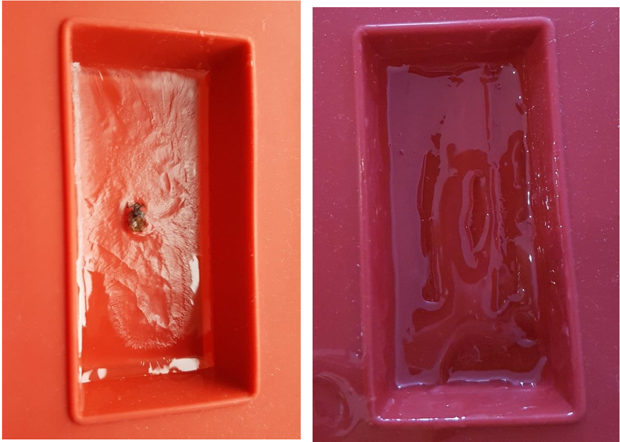
Figure 19 : Photos de résines non homogènes, craquelées et liquides à certains endroits (Résultats après 4 jours de séchage)
