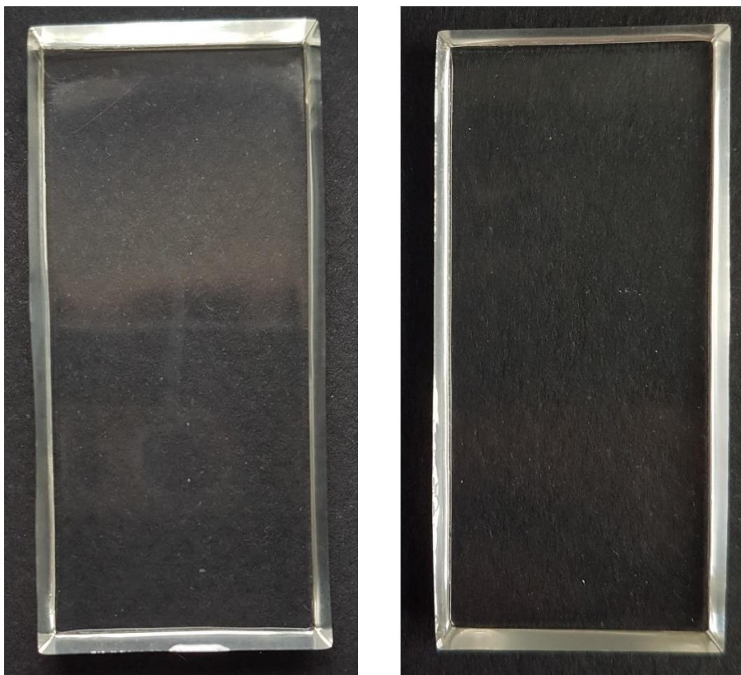
Figure 26 : Photos de résines dégazées à l'aide d'une pompe à vide (a) dans le verre doseur avant coulée dans le moule (gauche) et (b) dans le moule (droite)
