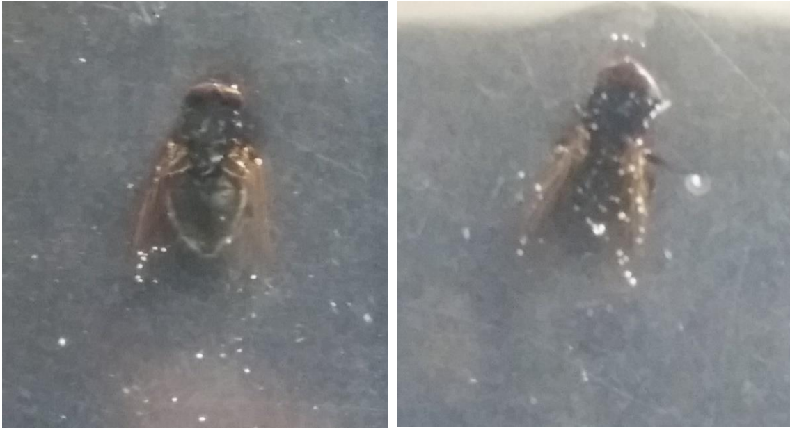
Figure 35 : Photos de comparaison de bulles retirées par une flamme (à gauche) avec bulles retirées par la pompe à vide(à droite) sur deux mouches incluses en résine
