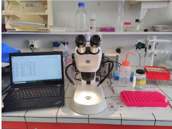
Figure 34: Organisation du poste de travail : La loupe binoculaire au centre pour regarder individuellement chaque tique; le porte tube pour placer les Eppendorfs contenant une tique sexée et identifiée ; l'ordinateur pour récupérer les informations dans un fichier Excel
