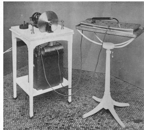
Figure 62 : Matériel de Doyen pour l'électro-coagulation thermique<sup>221</sup>
