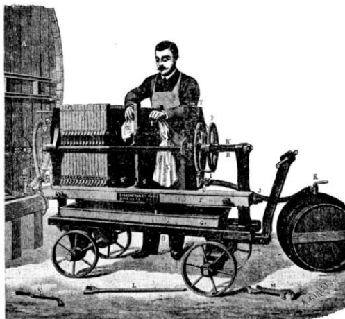
Figure 100 : Filtre-presse Simoneton, relié à gauche à un foudre 214 (Source : RetroNews)
