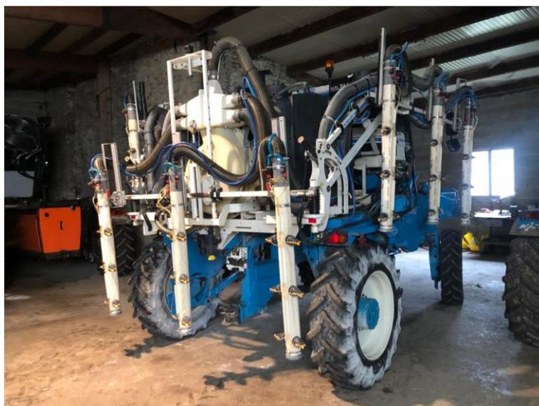
Figure 7 : Enjambeur et matériel de pulvérisations utilisé pour les traitements.
