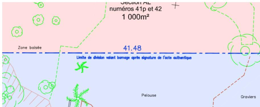
Figure 3 : le géomètre marque sur le plan que la limite de division vaudra bornage lorsque l'acte authentique sera signé par les différents partis. (archives Qualigéo Expert).
