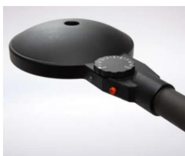
Figure 13 : Bobine arrondie utilisée par l'équipe de Walendy et al. (2022). Cette bobine a comme objectif de mieux épouser la forme du crâne du cheval.
