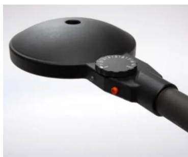
Figure 13 : Bobine arrondie utilisée par l'équipe de Walendy et al. (2022). Cette bobine a comme objectif de mieux épouser la forme du crâne du cheval.
