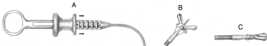
Figure 9 : détails d'une pince à biopsie avec des mors dentelés et une pointe centrale permettant de s'ancrer dans la muqueuse d'après Mac Carthy (2005)
