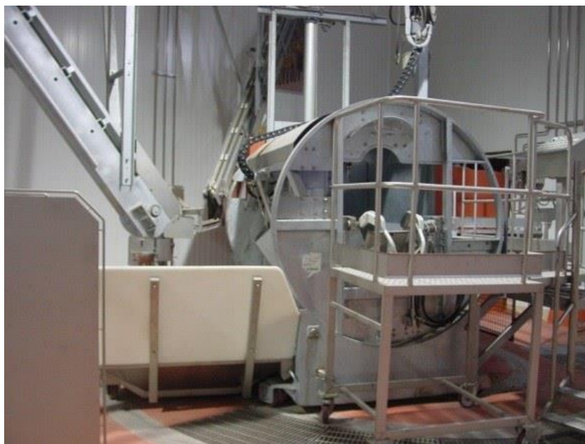
Figure n°12 : Piège rotatif pour l'abattage rituel des bovins (Couédic Madoré, 2016)
