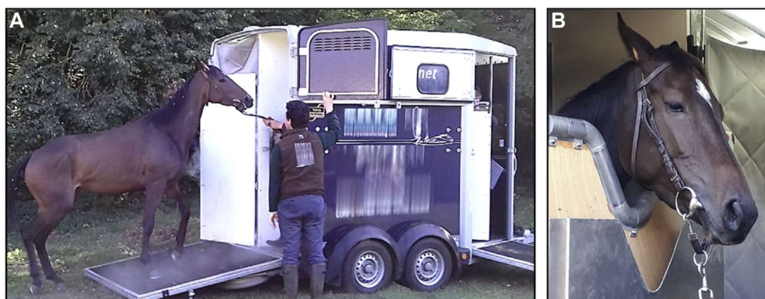
Figure 3 : Cryocabine destinée aux chevaux (A). Position de la tête dans la cryocabine (B) (d'après Bogard et al. , 2020)
