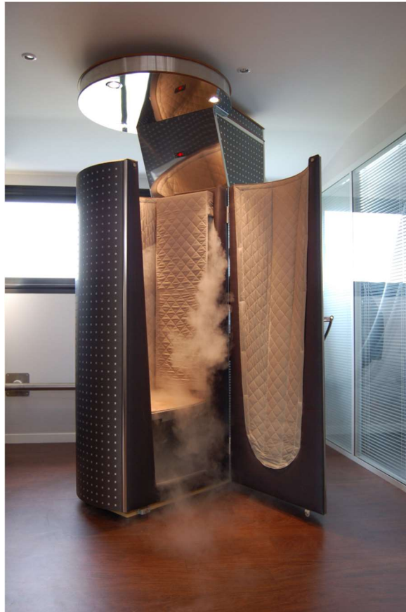
Figure 1 : Cabine individuelle fonctionnant à l'azote liquide Criotec (d'après Adam, 2014)
