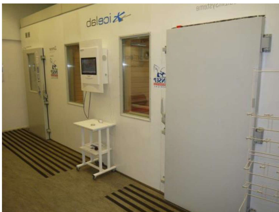
Figure 2 : Cryochambre 3 pièces (d'après Ben Khedher Balbolia et al. , 2019)
