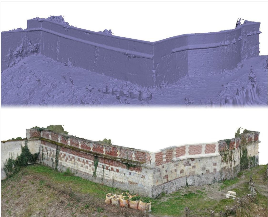
Figure 113 : Relevé photogrammétrique du mont Thabor. ©Maxence Toubin
