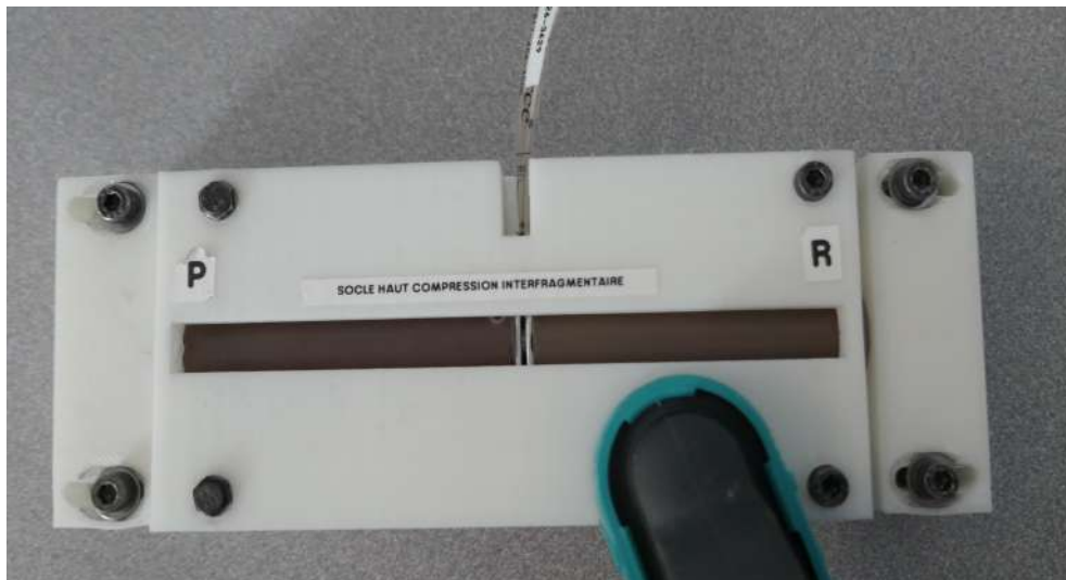
Figure 25 : Illustration représentant le dispositif expérimental après mise en place du serre-joint.
