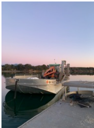
Figure 8 - Chaland équipé d'un bras mécanique et de deux remonte-charges en Corse (photographie février 2022)
