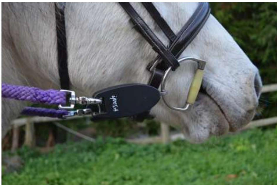
Photo 6 : Capteurs branchés au mors et aux rênes (© C. Lannes)
