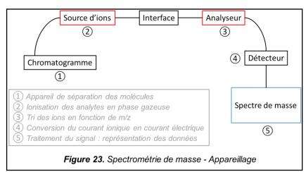
masse/charge (m/z), et permettre d'analyser les échantillons de deux manières :
