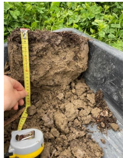
Figure 3. Photographie de la structure du sol prélevé après extraction et avant étude interne, lors du test bêche structure - modalité W (témoin travaillé)
