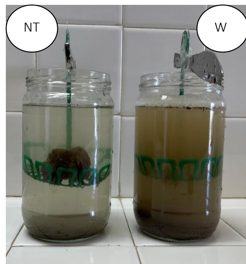
Figure 8. Slake test : photographie du test en cours, par modalité (NT = système MSV, W = témoin travaillé), après 5 minutes d'immersion en statique
