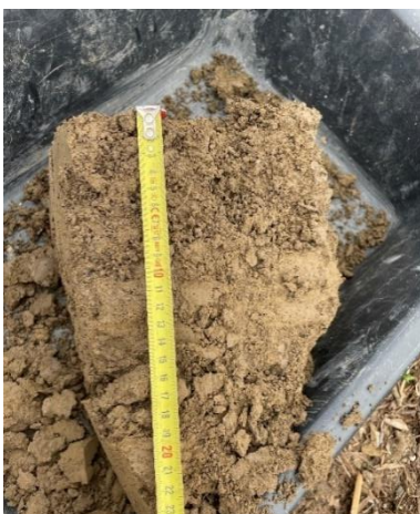
Figure 4. Photographie de la structure du sol prélevé après extraction et avant étude interne, lors du test bêche structure - modalité NT (système MSV)
