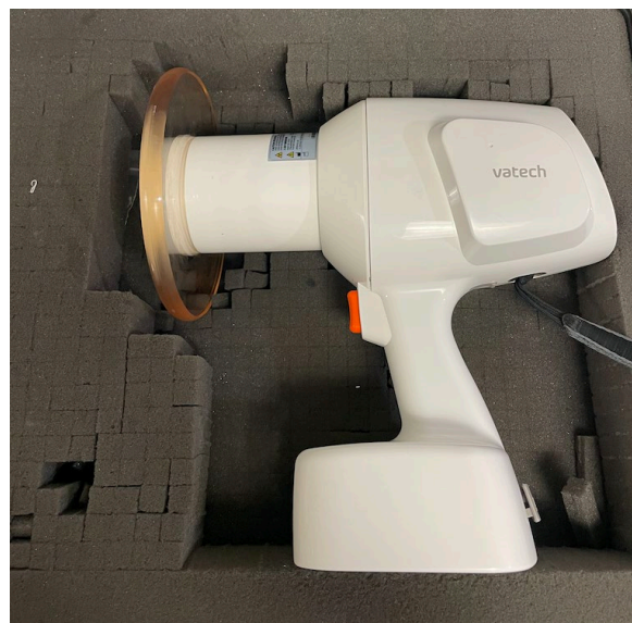
Figure 13 : Générateur de radiographie portatif, Actuellement disponible au sein du pôle odontologie de l'AP-HM, dans les services d'urgences dentaire et d'odontologie hospitalière, Iconographie personnelle.
