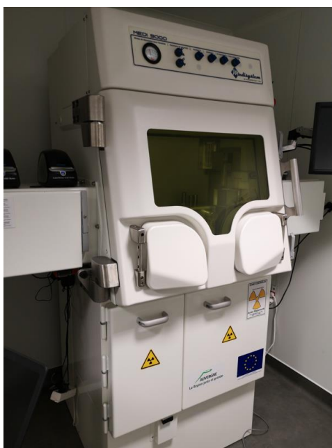
Figure 7 : Enceinte à haute énergie, Medisystem®.
