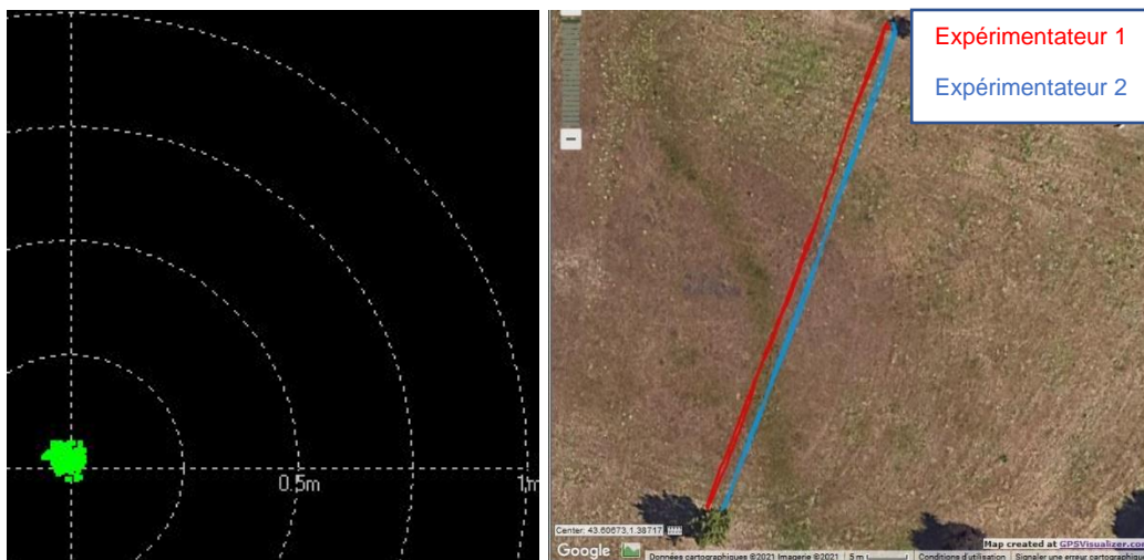
Figure 16 – Essais du matériel en amont de la réalisation des tests. A gauche : Données obtenues après avoir laissé un GPS posé sur le sol pendant 5 minutes, visualisation de ces données par le logiciel u-center® (version 21.05, produit par l'entreprise u-blox, Zürich). A droite : trajectoires obtenues par les GPS portés par deux expérimentateurs marchant en ligne droite à environ un mètre de distance. Carte créée à partir de Google Maps® et du site internet https://www.gpsvisualizer.com/ .
