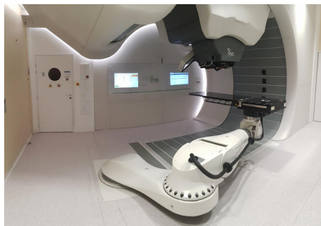
Figure 33 : Salle de traitement avec le bras isocentrique et la table de traitement robotisée Source: lejournal.cnrs.fr/les-promesses-de-lhadrontherapie
