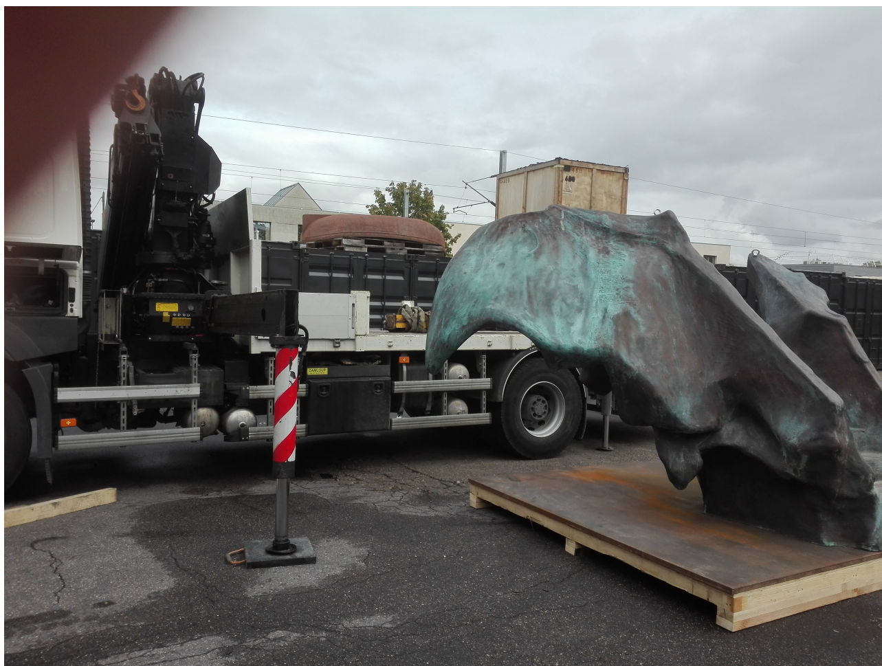
Stabilisateur sur vérin, ici en rouge et blanc
